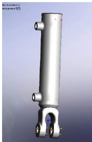
Рисунок 4.5 – Модель гидроцилиндра, созданная в SolidWorks
